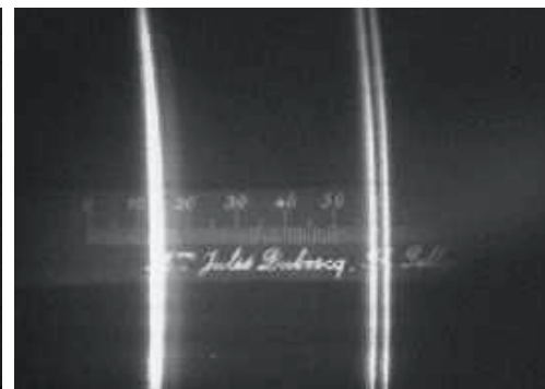
Fotografia ampliada de l'espectre del sodi. El doblet correspon a la ratlla groga i la diferència és de 6 Å.
